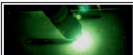
Что видит сварщик через обычный светофильтр.
